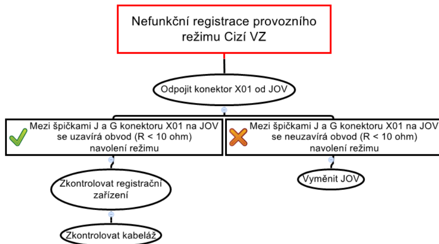
Obr. 20: Lokalizace vadného dílu při poruše Nefunkční registrace provozního režimu Cizí VZ
